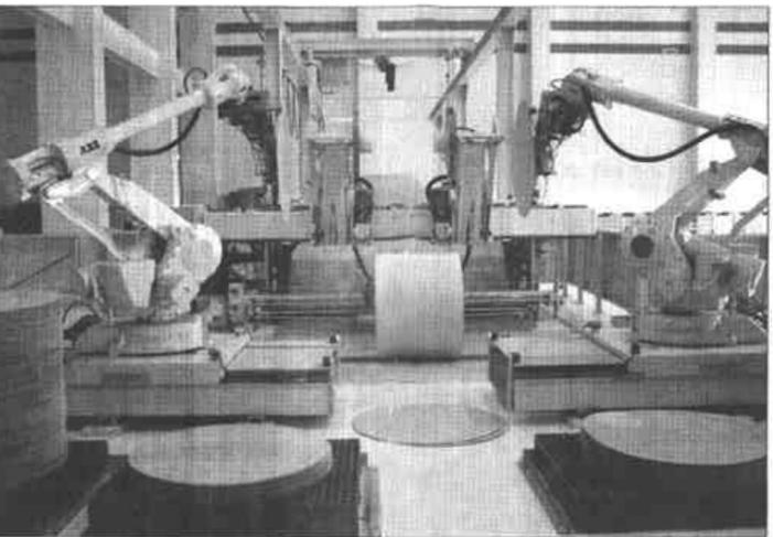
近年来，我市工业取得了突飞猛进的发展，现代化的设施装备进入了厂房车间。华泰集团今年7月份引进上产的德国福伊特集团生产的年产20万吨彩印新闻纸全自动卷线，在大大减轻劳动强度的同时，生产效率更是大幅度提高。图为该集团生产车间的机械手在自动化作业。（记者 高梓 摄）
